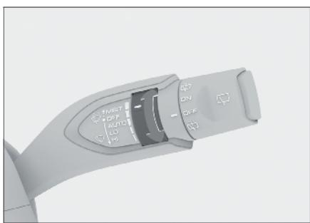
Чувствительность датчика осадков можно изменить путем вращения регулировочной ручки, что позволит изменить частоту работы щеток очистителей ветрового стекла в автоматическом режиме.
