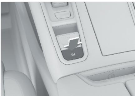
При движении на склоне, остановке перед красным сигналом светофора и движении с частыми остановками функция автоматического удержания автомобиля (AVH) позволяет водителю не удерживать педаль тормоза длительное время и не активировать стояночный тормоз. Это обеспечивает более комфортное вождение и снижает риск скатывания автомобиля.
