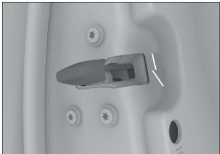
Чтобы заблокировать дверь, вставьте механический ключ в замочную скважину аварийного замка, поверните его по часовой стрелке, а затем закройте дверь.
